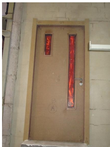
-Time 42 min. Smoke output doorset B-
